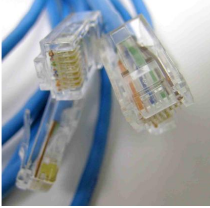
Figura 8: Terminales o conectores RJ 45 requeridos por el cable UTP actual
